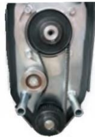
Zahnriementrieb mit Riemenspanner
